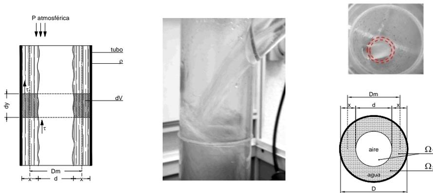
Teniendo en cuenta que el diámetro de la columna de aire “d” es la de la tubería “D” menos 2 veces el espesor “x” de la lámina de agua adherida a la pared de la bajante. Las limitaciones de “x” pueden expresarse según distintos autores como:
