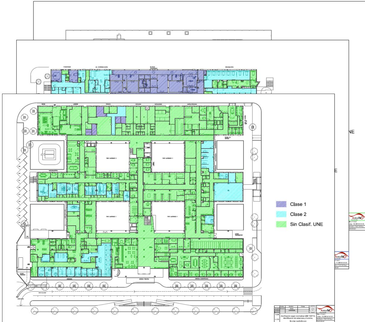
Dicha clasificación se realizó en base a la tabla 5 de la norma UNE 100713, que establece rangos de valores admisibles para temperatura, humedad relativa, ruido y caudal de aire impulsado.
