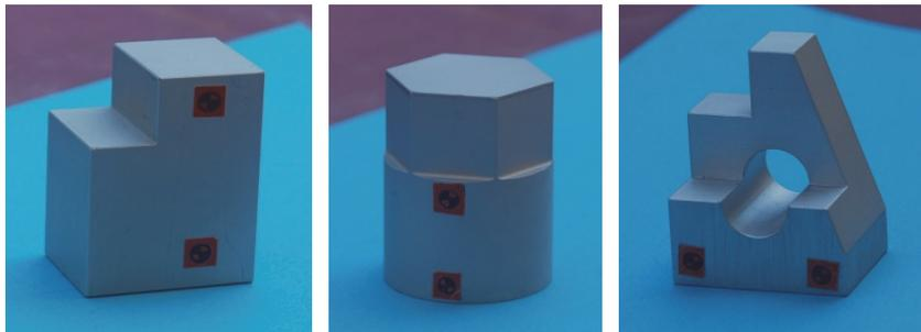
Una vez obtenido el factor de escala dentro de un modelo, se puede proceder a realizar cualquier medición sobre la pieza (Fig. 10). Como se puede comprobar en la tabla 1, se han obtenido diferentes factores de escala en las tres piezas seleccionadas, por lo que es preciso realizar este proceso de forma independiente para cada pieza del estudio.
