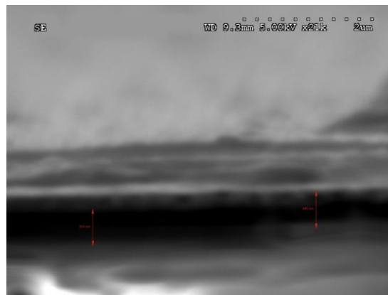
Figura 7: Espesor de la película depositada sobre el vidrio observada en microscopio electrónico de barrido (485, 554 nm). Escala de 2 \mu m
