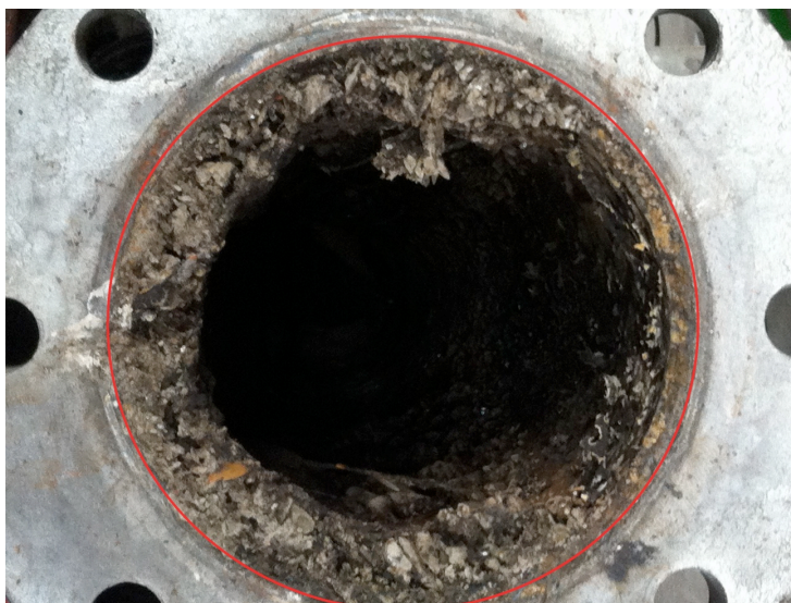
Figura 1: Precipitación incontrolada de estruvita
