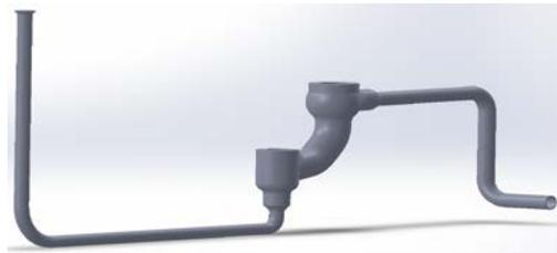
La geometría está compuesta por dos tuberías de conducción de alta presión y dos cuerpos de válvulas de alimentación de vapor a proceso. Es una geometría aplicable a todo rango de aplicaciones industriales donde se utilice este tipo de fluido presurizado. El vapor provendría de una caldera de producción de vapor o tanque flash desde el lado derecho, pasaría por las dos válvulas de control y ascendería para ser introducido en el proceso pertinente.
