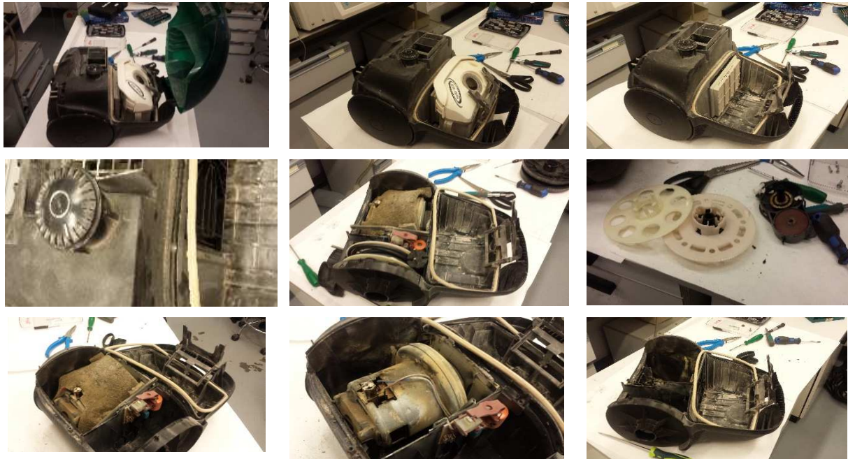
Figura 3. Ejemplo del proceso de desensamblado de uno de los aspiradores analizados
