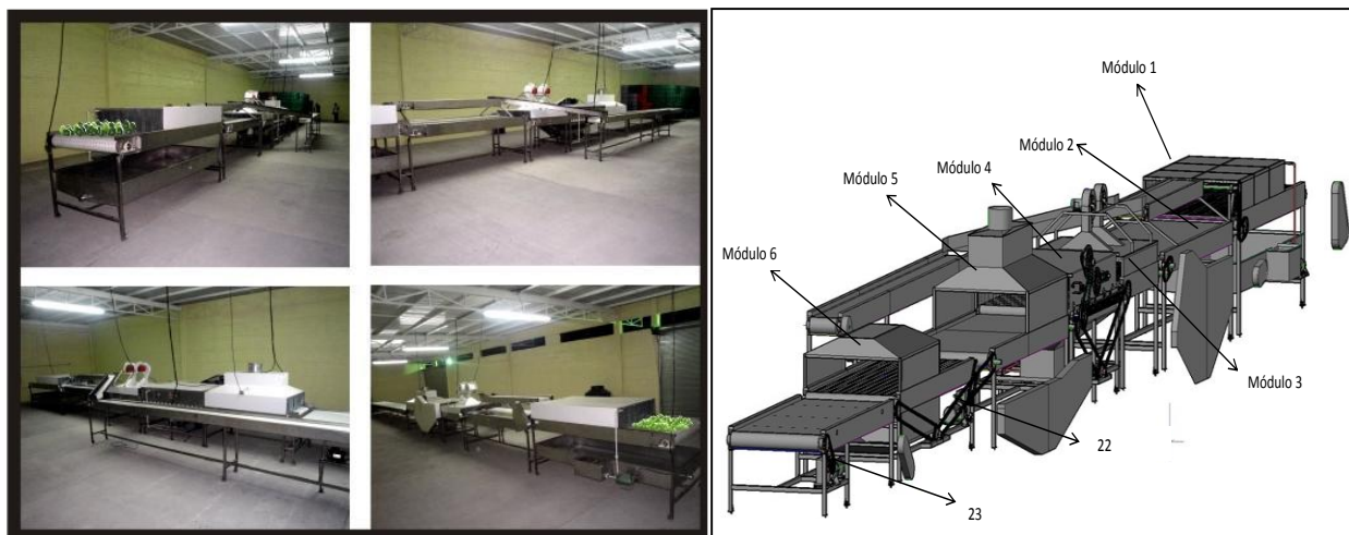
Figura 4. A: Sistema de bioseguridad para reducir daños físicos y carga microbiológica en frutos de chayote procedente de campo. B: Diseño del equipo mostrando cada módulo del tren de flujo continuo que lava con agua azonificada, seca, encera, seca y desinfecta con luz UV.
