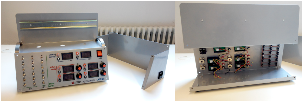
Figura 7: Bastidor con los elementos montados y conexionado interior
