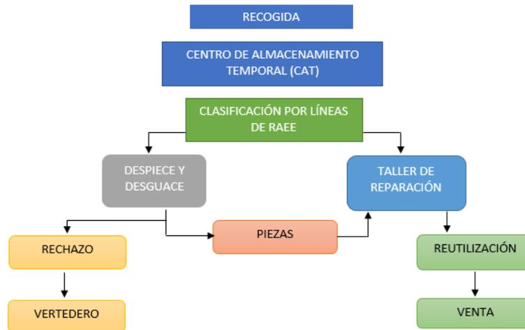
Una vez recibidos los RAEE, se identifican y se obtiene el peso de cada uno de ellos. A continuación se lleva a cabo la etapa de clasificación, que consiste en la inspección visual, en pruebas de seguridad del funcionamiento eléctrico y en la comprobación del consumo energético de cada aparato, con el fin de verificar cada uno de ellos y poder valorar la viabilidad de cada reparación antes de enviarse a las plantas de reciclaje.
