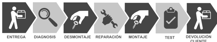
Figura 3.- Procesos que sigue la reparabilidad de un producto
