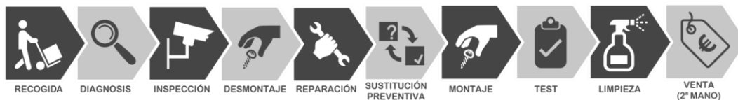
Figura 6.- Procesos necesarios para el reacondicionamiento de un producto
