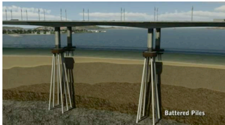
Figura 1. Ilustración de las pilas del nuevo puente de la Bahía de San Francisco, cimentadas sobre pilotes inclinados (Caltrans, 2012)
