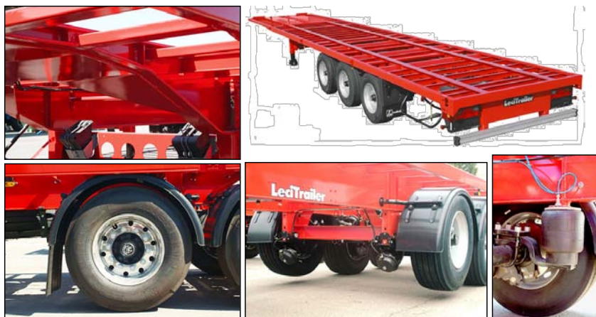
Figura 1: Detalles de estructura de un chasis de semirremolque
