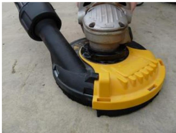
Figura 3: Punto de toma de sistema de extracción para una amoladora. Fuente: HSE
