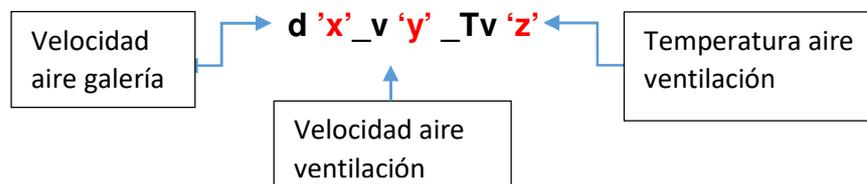
Por tanto, el caso d1.5\_v10\_Tv298, se corresponde con velocidad de aire en la galería 1,5 m/s, velocidad aire de ventilación/refrigeración 10 m/s y temperatura 298 K.
