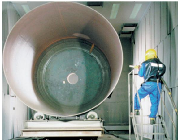
Figura 2: Tarea de chorreado en sala de chorreado
