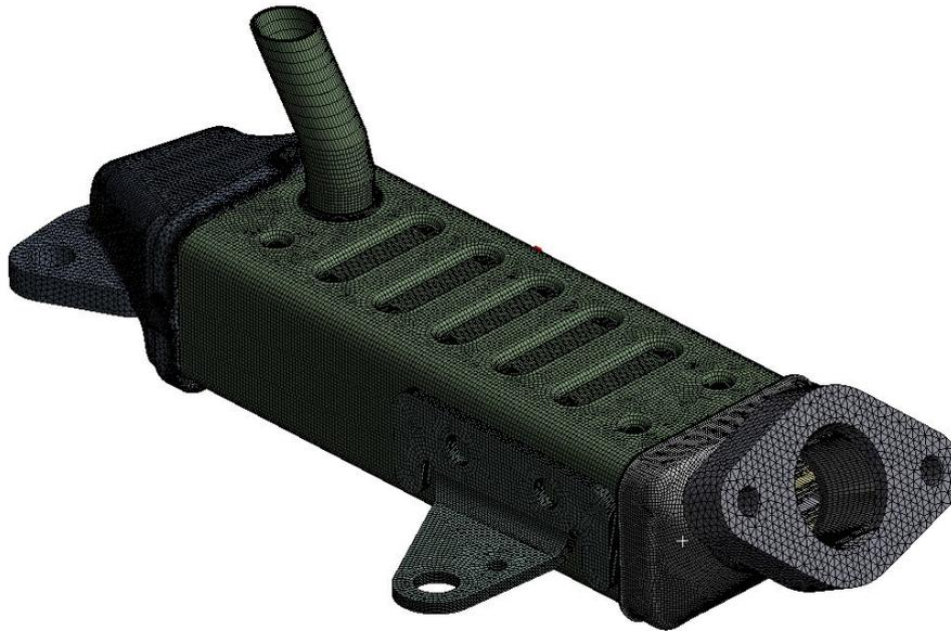
El mallado final obtenido, el cual se muestra en la figura 9 está formado por diferentes tipos de elementos. Concretamente elementos tipo Shell han sido empleados en el mallado de los tubos. El resto del modelo ha sido discretizado con elementos hexaédricos, a excepción de las zonas en las cuales no ha sido posible, por ejemplo los tubos de gas, los cuales han sido mallados con elementos tetraédricos.
