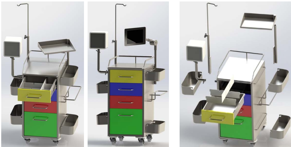
Figura 16: Vista conjunto final/explosionada con mesa auxiliar/tablet
