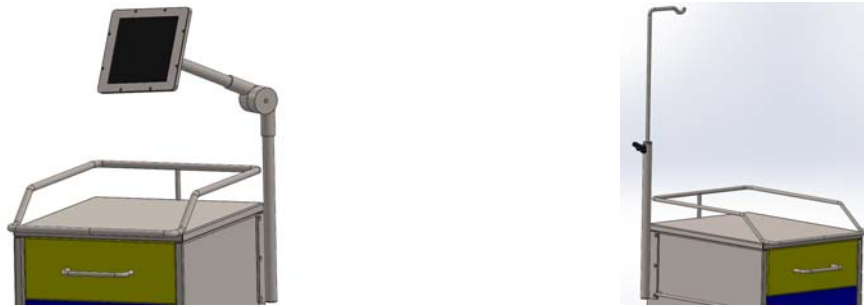
Figura 14: Vista soporte para Tablet y gotero
