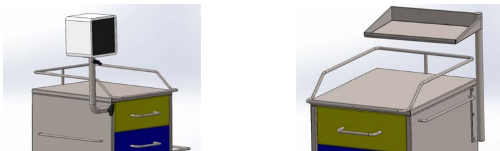
Figura 13: Vista del soporte para tensiómetro y bandeja auxiliar
