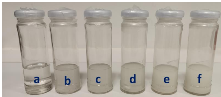
Figura 2: Disoluciones de CAb/HA preparadas con diferentes proporciones de HA: a) 15CAb-0HA, b) 15CAb-10HA, c) 15CAb-20HA, d) 15CAb-30HA, e) 15CAb-40HA y f) 15CAb-50HA
