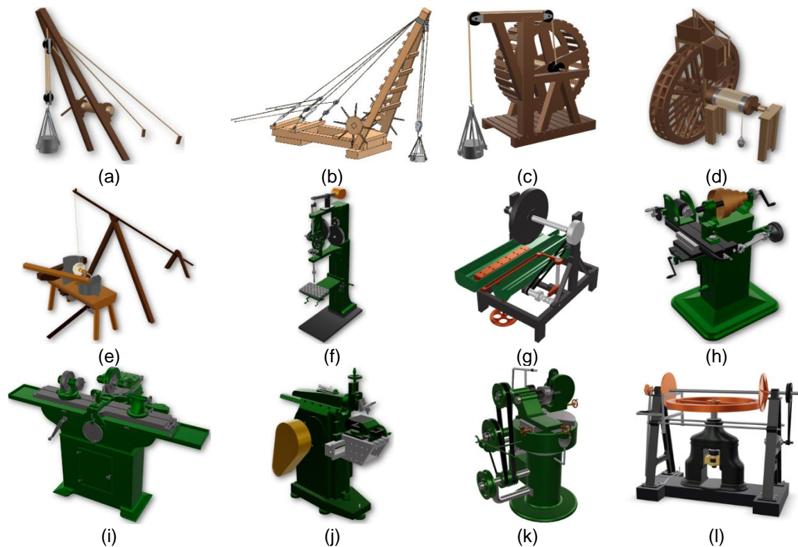
Figura 8: Modelos digitales incluidos en el museo virtual: a) grúa egipcia; b) tripasto griego; c) grúa romana-medieval; d) grúa renacentista; e) torno de pedal y pértiga; f) taladradora de columna; g) rectificadora de superficies planas; h) fresadora universal; i) rectificadora universal; j) limadora; k) rectificadora de rodamientos; l) prensa de husillo a fricción
