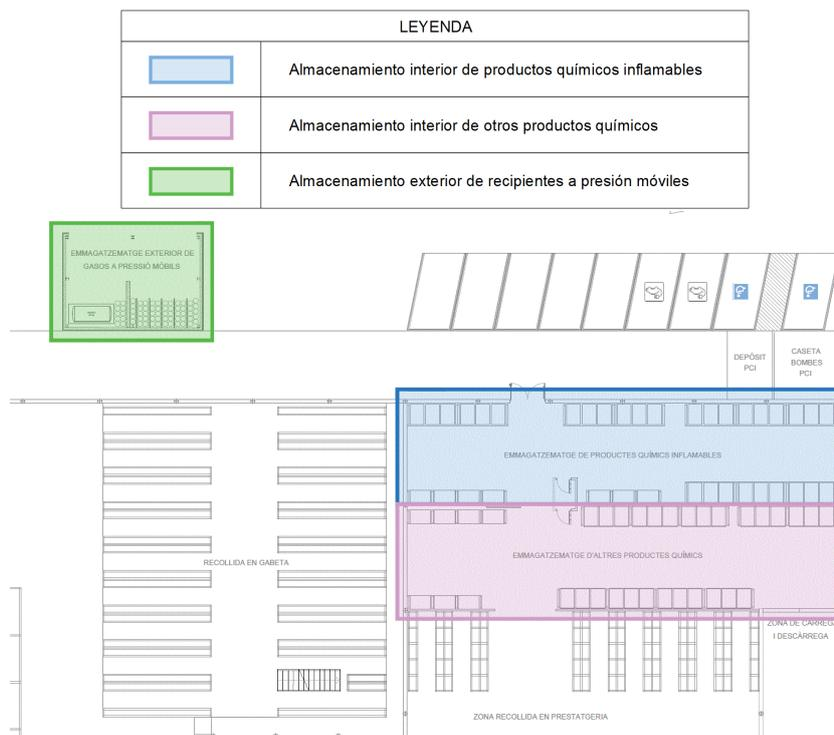
El almacén exterior consiste en un recinto abierto. La pared trasera pertenece a la nave industrial, las paredes laterales y cubierta serán de nueva construcción y carece de pared frontal. Cuenta con una superficie rectangular aproximada de 46,15 m<sup>2</sup>, cumpliendo todas las distancias de seguridad y eliminando el menor número de plazas de aparcamiento.
