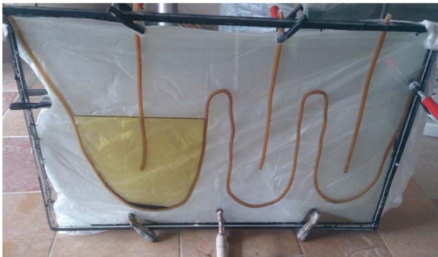
**Figura 5: Decantador lamelar diseñado. (Fuente: Elaboración propia)**
