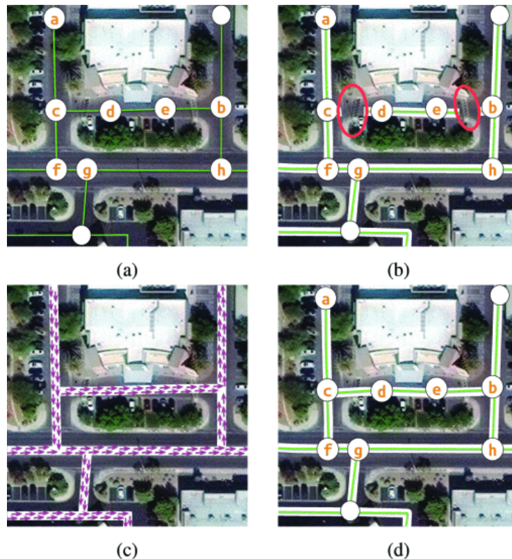
Figura 4: Imagen de ejemplo del uso de la orientación junto a la segmentación para extraer un mapa de carreteras más acertado. (a) es la imagen de máscara, creada a mano. (b) es representa el resultado de una segmentación tradicional. (c) carreteras trazadas con orientación. (d) resultado obtenido de juntar ambas técnicas. Imagen procedente del artículo Batra et al. (2019).
