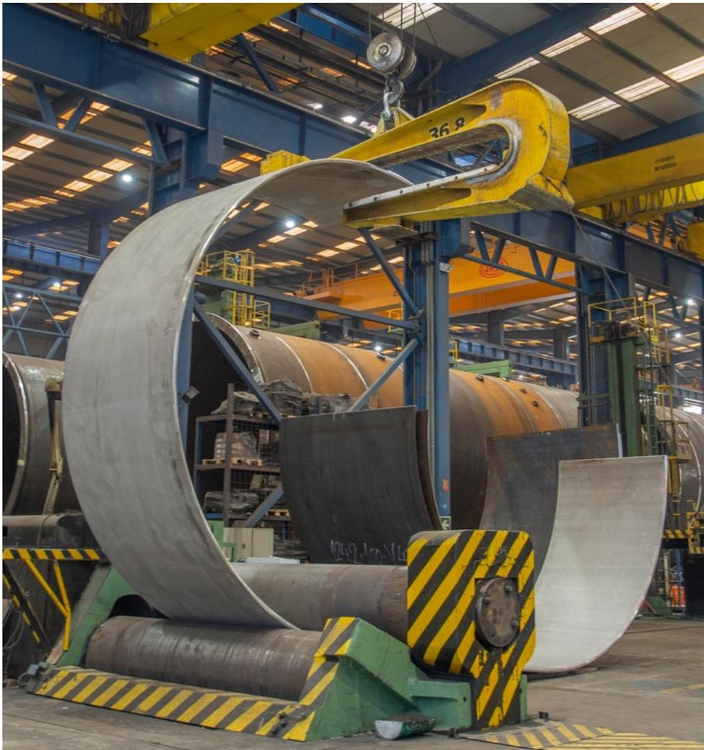
Durante el proceso de curvado la medición de la curvatura que va adoptando la chapa se realiza mediante el uso de una serie de plantillas curvas que poseen la curvatura correspondiente al de la circunferencia de la virola que se pretende lograr, de tal forma que el operario verifica en cada momento la curvatura que se va logrando. Esta medición
