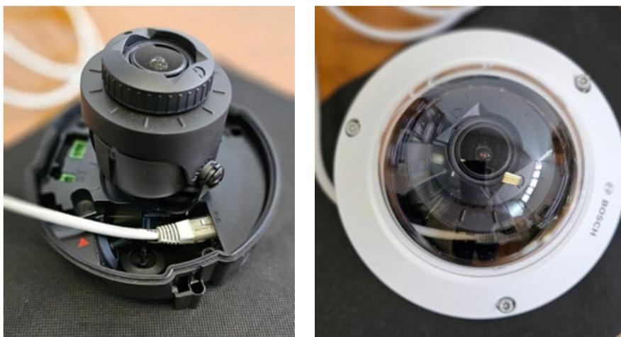
De entre ellas se eligió la cámara **NDE-5703-A**, de la marca **BOSCH**. Esta cámara se trata de una cámara de vigilancia profesional para realizar seguimiento en exteriores, que monta un sensor de 1/2,7". Posee un objetivo zoom de 3,2-10,5mm, y una protección IP66, además de contar con un domo de protección.
