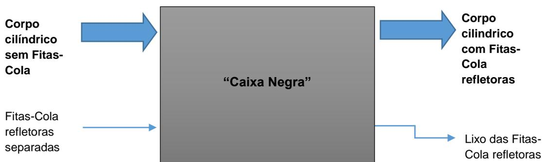
O esquema da caixa negra do projeto resume aquilo em que este consiste, ou seja, através da junção do Corpo cilíndrico, sem Fita-Cola refletora, com a Fita-Cola refletora separada (o termo separada significa que o papel auxiliar já foi descolado da Fita) obtém-se o produto final desejado, ou seja, um corpo cilíndrico com as Fitas-Colas refletoras acopladas neste.
