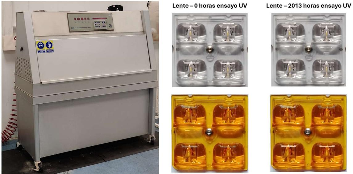
**Figura 5: Evolución de la TC y rendimiento de emisión de lentes transparentes en función de la degradación por UV. [Fuente: elaboración propia]**
