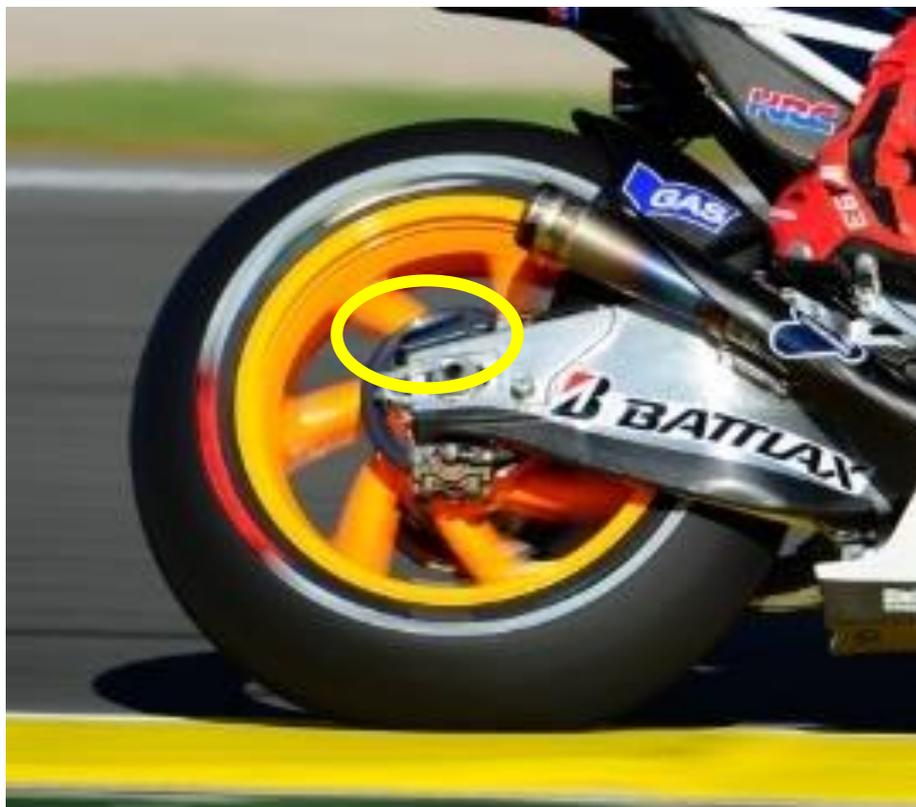
En la temporada 2014, los diferentes equipos hicieron un rediseño de los guardabarros traseros, de manera que el cable que fue cortado, quedaba protegido y de esta forma se evitaba una condición de riesgo similar a la que se tuvo en la carrera de 2013. En la siguiente ilustración, figura 5, se muestra el diseño del guardabarros de la motocicleta para la temporada 2014 del equipo Repsol-Honda en MotoGP.
