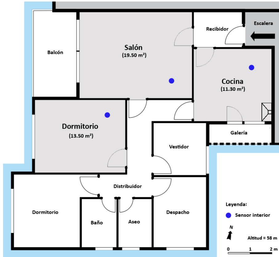
Figura 1: Distribución vivienda prototipo y ubicación de sensores
