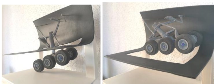
Figura 19: Prototipo realizado mediante fabricación aditiva y movimiento de retracción
