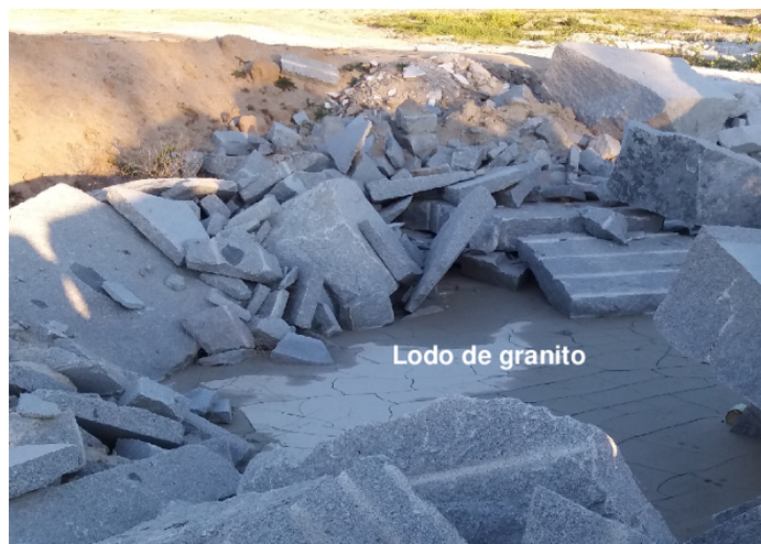
Figura 2. Lodos depositados en escombrera
