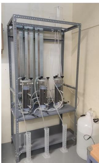
**Figura 4: Sistema de columnas de lixiviación desarrollado.**
