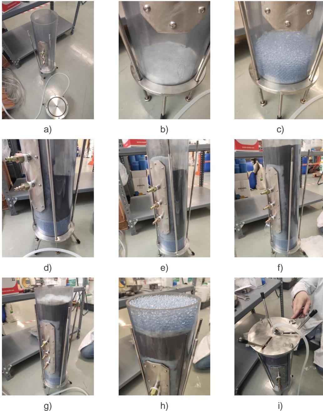
**Figura 3: Proceso de montaje de célula con una capa de material.**
