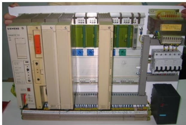
Figura 1: Autómatas programables Siemens
