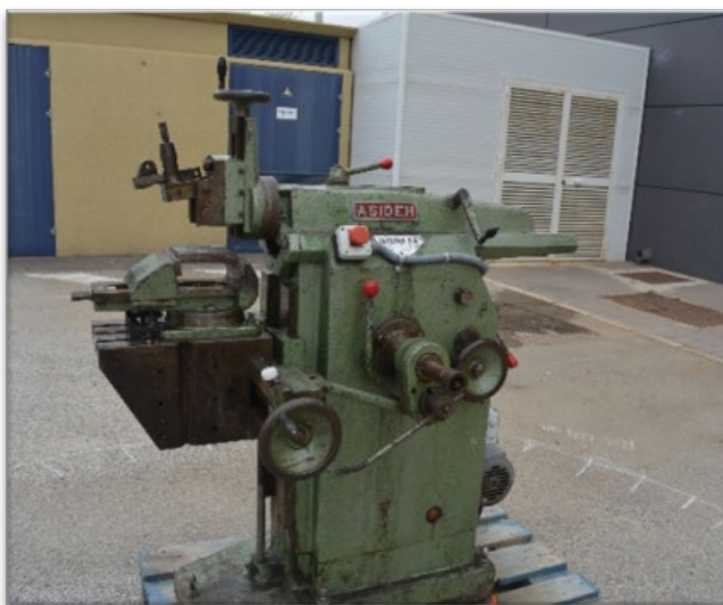
Figura 1: Limadora semiautomática para obtención de modelo digital mediante fotogrametría
