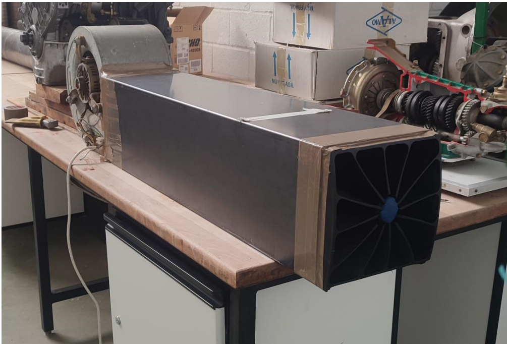
Figura 4: Ensayo de análisis de flujos de aire a la salida de un tubo de sección cuadrada
