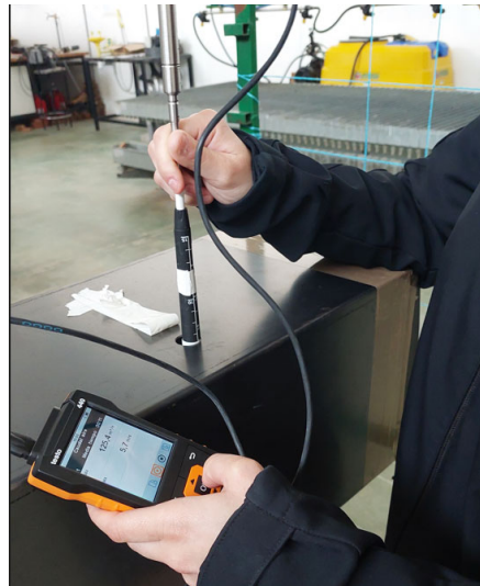
Figura 8: Medida de velocidad el aire en el interior del tubo
