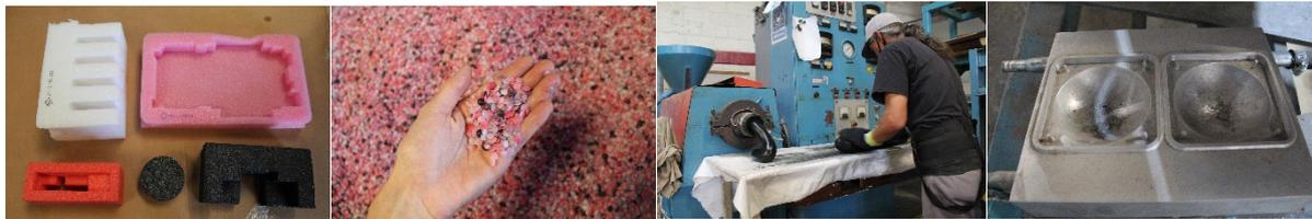
Nota: Proceso de trabajo en la empresa, de izquierda a derecha: muestras de espuma de polietileno, pellets reciclados, extrusora de plástico y molde de aluminio de la boya.
