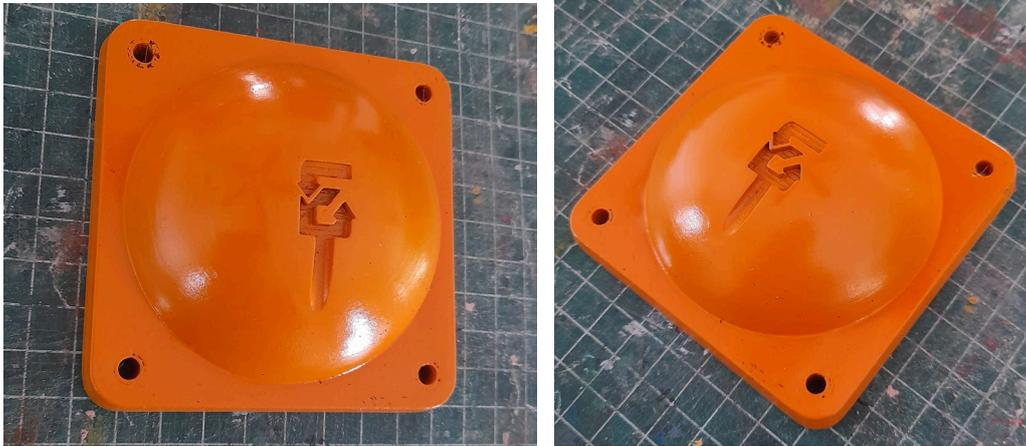
Nota: Prototipo finalizado, con el tamaño real y color aproximado que resultarían del molde modificado y el material con pigmento.
