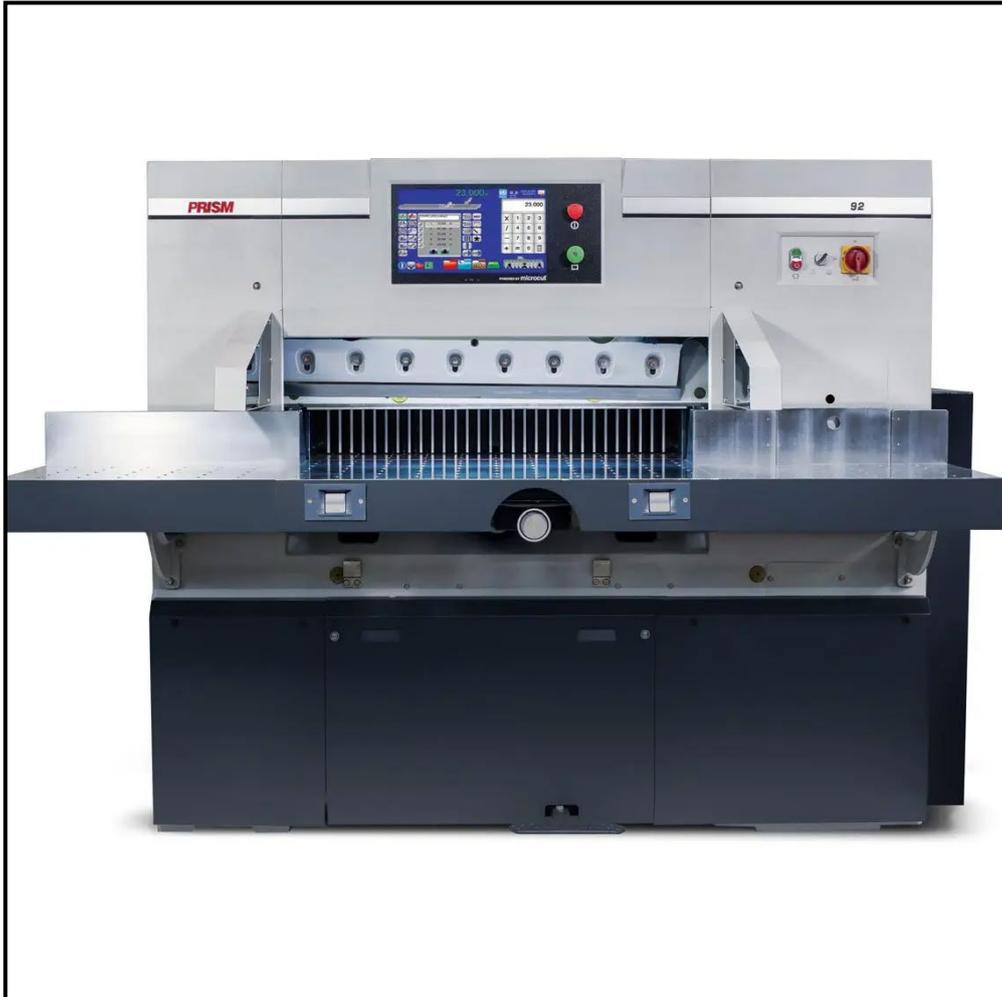
Durante el ciclo de vida de la máquina, la cuchilla debe garantizar un corte adecuado, sin rebabas. Para ello debe ser afilada varias veces durante la vida útil de la misma.
