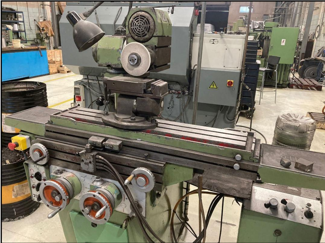
Como puede apreciarse en la imagen 2, la máquina herramienta dispone de una muela, seleccionada en función del tipo de cuchilla, a la cual se la hace girar con una velocidad determinada, entre 1500 rpm y 6000 rpm, en función del tipo de corte y del material de la cuchilla.
