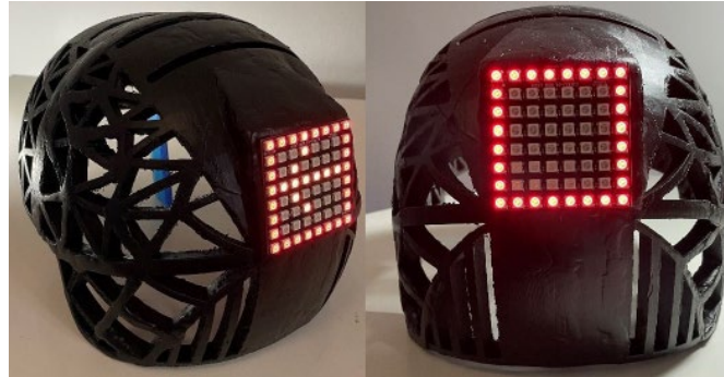
Figura 9. Verificación del funcionamiento de la matriz instalada en el casco.
