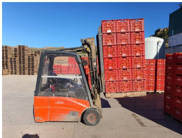
Figura 1. Carretilla cargando un palé con 36 cajones
