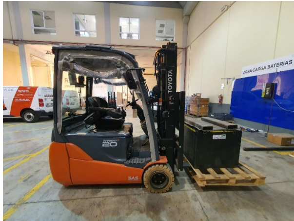
Figura 4. Carretilla estibadora TOYOTA 8FBET20
