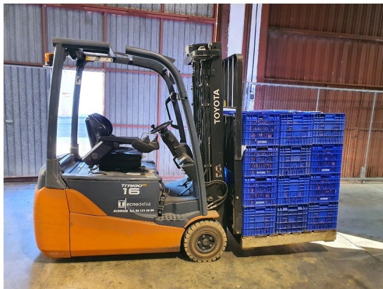
Figura 3. Carretilla estibadora TOYOTA 8FBET16
