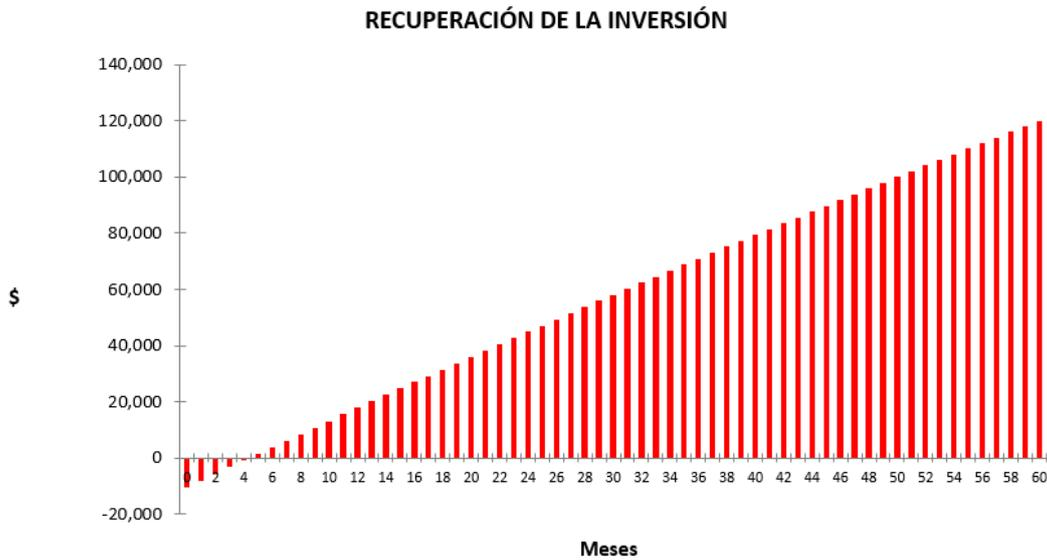
**Figura 11: Evaluación económica del aislamiento de la tubería de vapor a destilación.**
