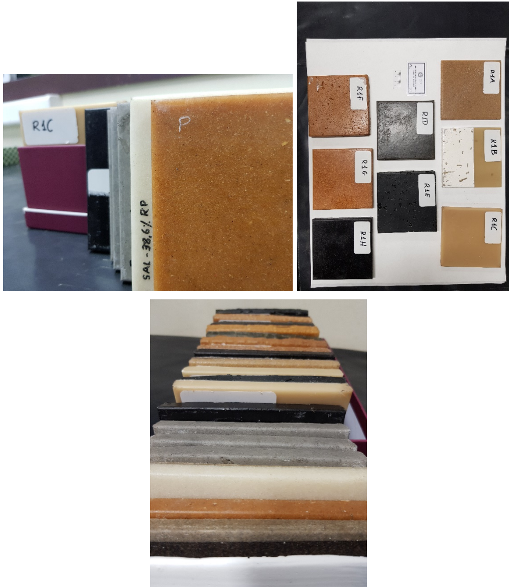
Figura 4 Probetas de hormigones flexibles sostenibles seleccionados para fase de desarrollo
