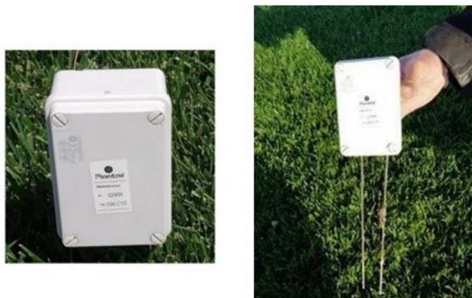
Figura 6: Modelo de sensores de humedad del suelo que plantea instalar el GOP en los ensayos
