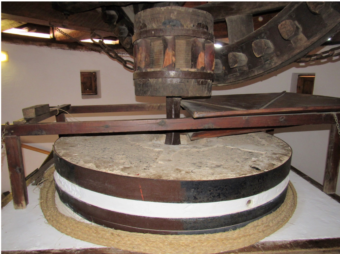
Figura 7: Molino El Infante (Campo de Criptana): linterna, tolva y piedras de moler.
