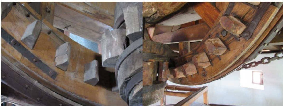
Figura 10: Dentado de la rueda catalina de los molinos Espartero y Rucio (Consuegra)
