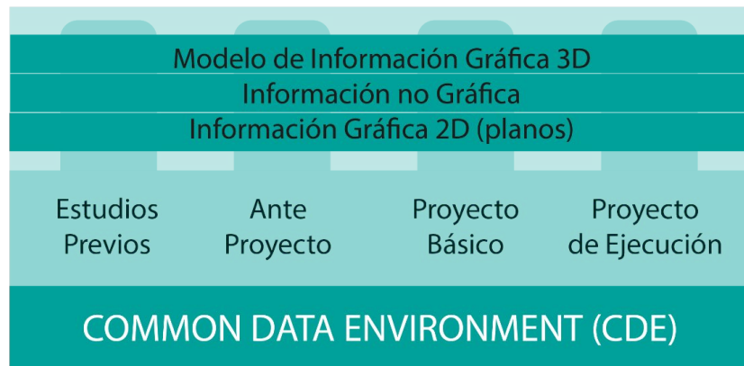
Figura 1. Tipos y niveles de información en los procesos de intercambio en el CDE (UNE- EN-ISO-19650)
