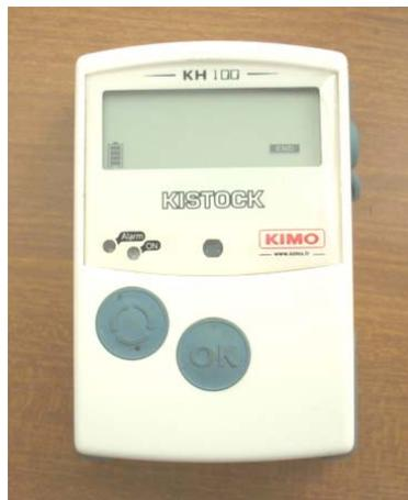
Figura 2. Registrador de Temperatura Humedad y Luz KH100
