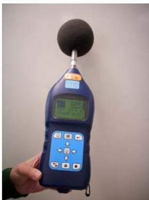
Figura 3. Sonómetro integrador CEL 400
