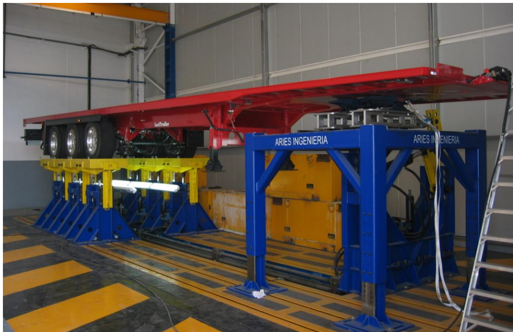
Figura 7: Prototipo en el banco de ensayos antes de colocar los bloques de carga
