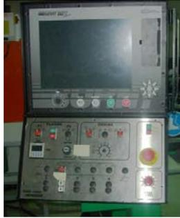
Figura 2. Módulo de control de la máquina de corte por plasma-oxigás
