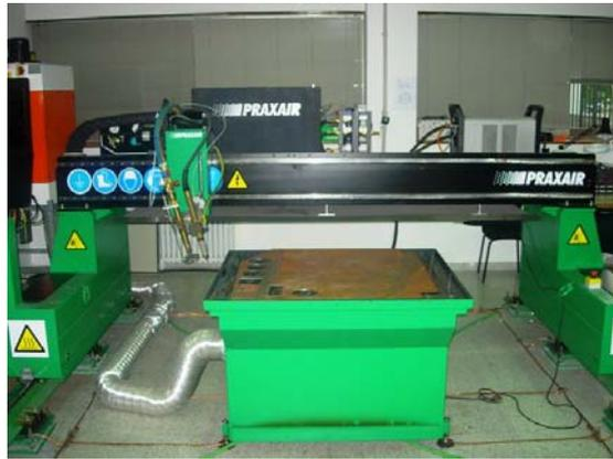
Figura 3. Unidad operativa de la máquina de corte por plasma-oxigás
