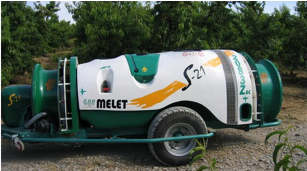
Figura 2: Pulverizador hidroneumático con dos ventiladores axiales con giro invertido
