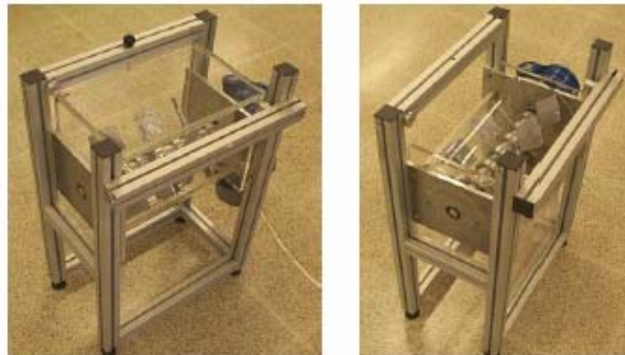
Figura 5. Sistema mezclador. Posición de operación y posición de descarga
