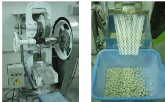
Figura 15. Máquina compresora empleada en las pruebas
