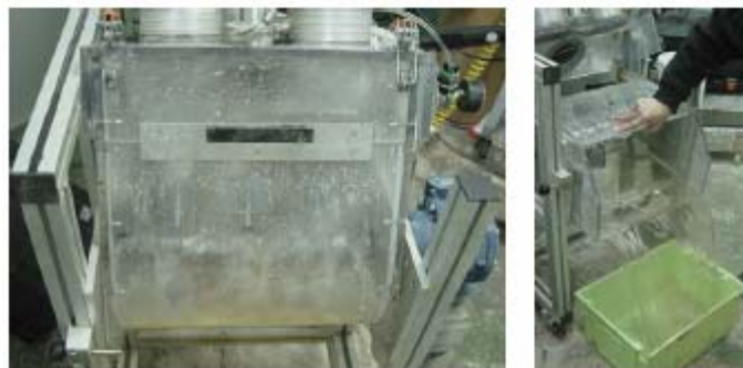
Figura 16. Limpieza con agua y descarga
