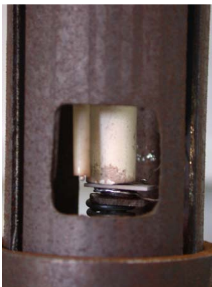
Figura 3. Detalle de la colocación de la muestra en célula de medida
