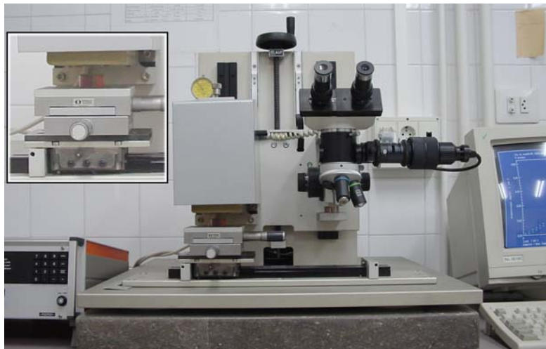
Figura 4. Equipo para ensayos de micro y nanoindentación.
